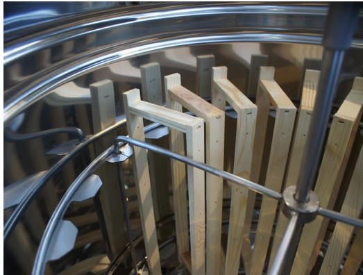
Foto2. La correcta disposición de los cuadros en una cesta radial
