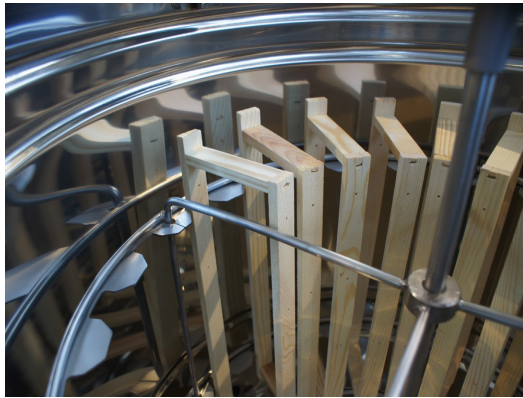
Foto2. La correcta disposición de los cuadros en una cesta radial
