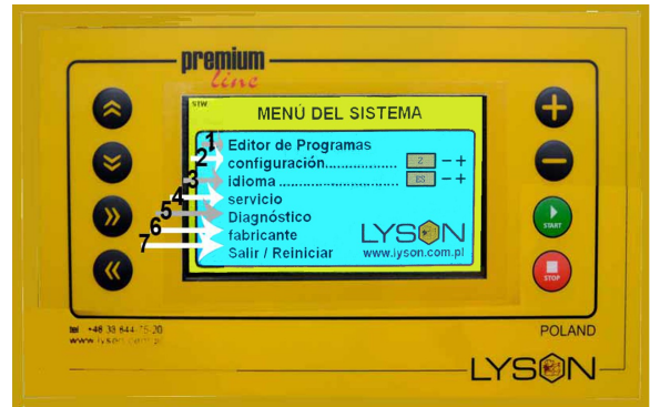
Foto 5 Seleccionamos el menú apropiado ayudándonos de las flechas "ARRIBA" y "ABAJO". Confirmamos la selección con la ayuda del botón "START".
