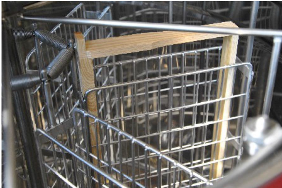
Fig.2 Disposición correcta de los cuadros en un extractor con cesta reversible
