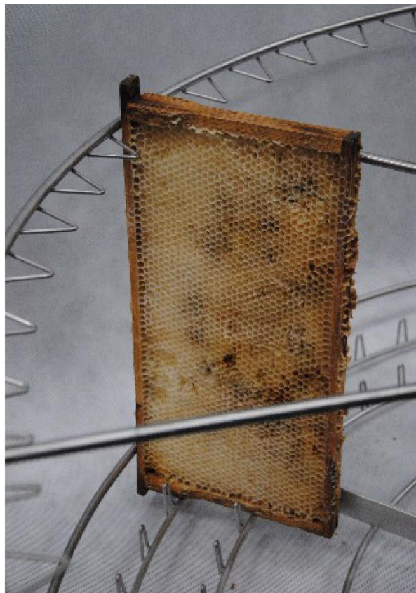
Fig.1 Disposición correcta de los cuadros en un extractor con cesta radial
